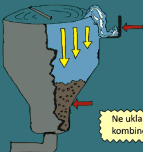
Čestice koje se sporije talože (suspendovane čestice), odvajaju se u primarnim taložnicima. Vodena fazra preliva preko rubova, a talog se rotirajućim zgrtačima usmerava na dalju obradu. Talog izdvojen u ovoj fazi prečišćavanja se naziva primarni mulj.
